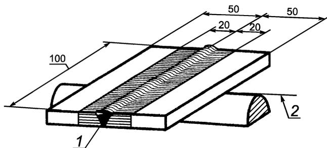
Рисунок Е.1 — Образец для испытаний, сваренный встык
