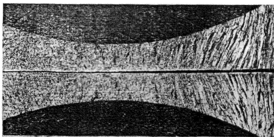
г — слоистый излом в краевой части заготовки
