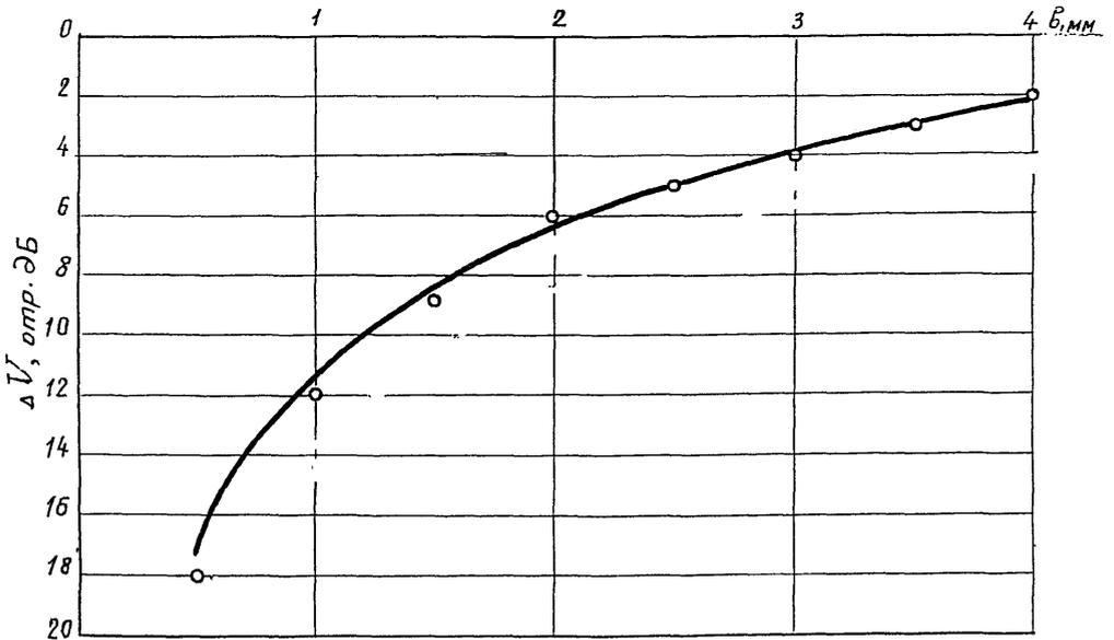
—, ○ - расчет и эксперимент соответственно для наклонных преобразователей при  $\delta_2 = 25$  мм,  $\alpha = 6$  мм,  $\beta = 50^\circ$  ( $\alpha = 65^\circ$ ),  $f = 2,5$  МГц,  $\Delta z = 6,5$  мм
