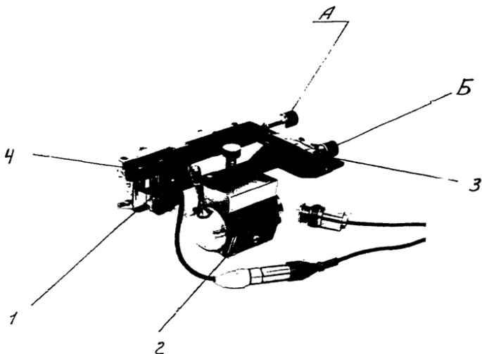
Держатель 2 предназначен для фиксации приспособления на контролируемом объекте; прижим приспособления постоянным магнитом обеспечивается поворотом ручки 4.
