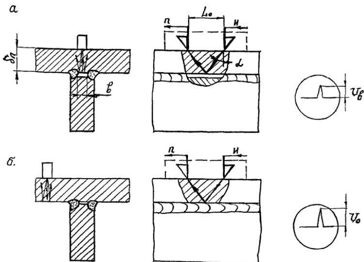
а - при определении амплитуды эхо-сигнала от непрявара в
