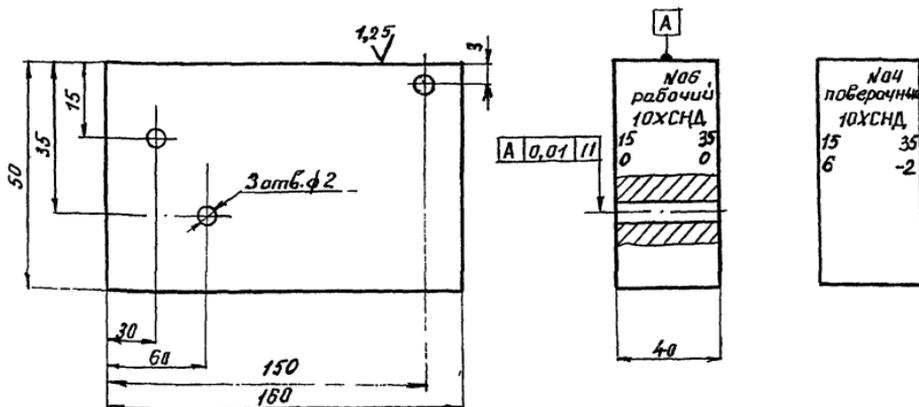
а) пример маркировки рабочего испытательного образца;
